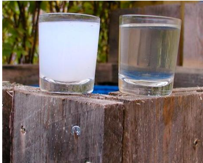
Vattenprov före och efter mullfilter.
